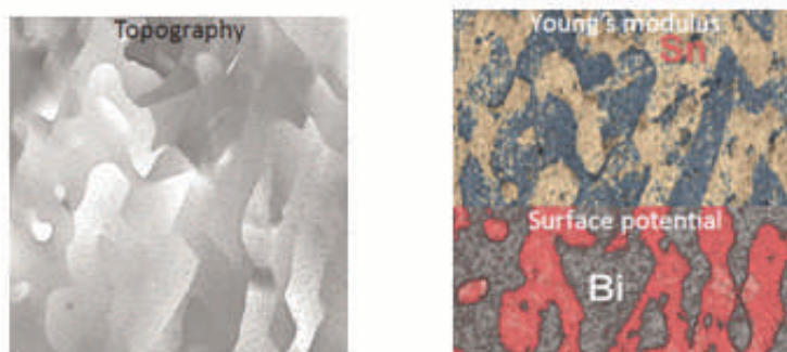
Рис. 5. Исследование сплава олововисмут прыжковой АСМ. Размер скана 10x10 мкм. Слева – топография, справа – поверхностный потенциал и модуль Юнга
